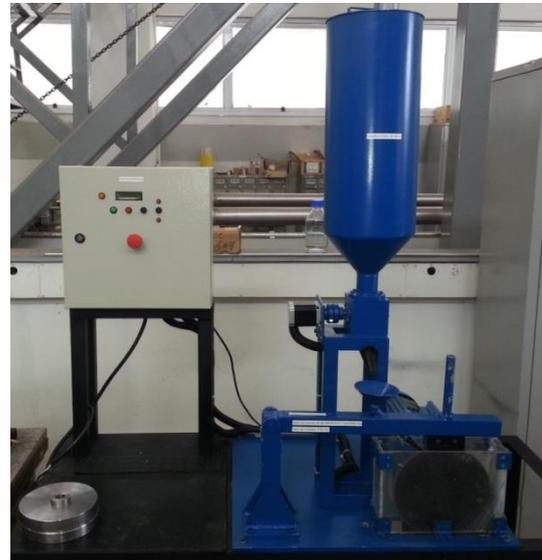
**Fig. 2**– Equipamento para ensaio de desgaste abrasivo do tipo “roda-de-borracha”.
