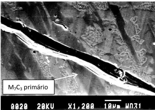
**Fig. 1** – Esclerometria retilínea aplicada a um ferro fundido branco de alto Cromo.
